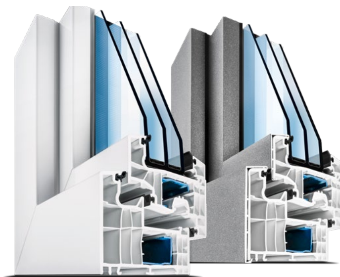
MD 92 ELEGANT und MD 92 ELEGANT AluColor Kunststoff-Profilsystem in flächenversetzter Bauweise, 92 mm Bautiefe, mit Mitteldichtung und drei Dichtungsebenen, U_w bis 0,74 W/m 2 K
