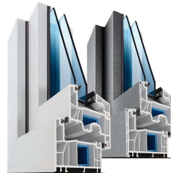
AD 76 PRO und AD 76 PRO AluColor Kunststoff-Profilsystem in flächenversetzter Bauweise, 76 mm Bautiefe, mit Anschlagdichtung und zwei Dichtungsebenen, U_w bis 0,85 W/m 2 K
